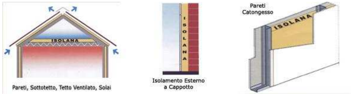
Figura 2. Esempi di applicazioni del pannello in lana di pecora Isolana in diverse tipologie di parete
